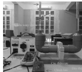
Hình 4. Sơ đồ thí nghiệm hiện tượng điện thẩm
