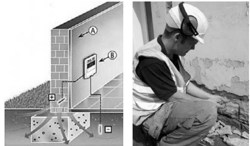
Hình 6. Sơ đồ lắp các điện cực và việc triển khai xử lý tường ẩm bằng kỹ thuật điện thẩm
