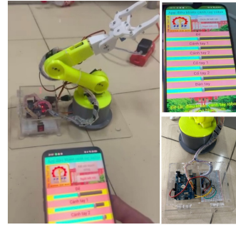
Hình 6. Mô hình robot được chế tạo cùng với giao diện và mạch điều khiển
